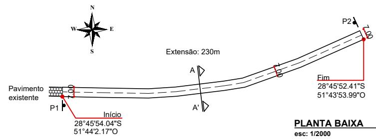
Pavimentação com paralelepípedos regulares de basalto (30 a 35 pedras/m<sup>2</sup>, 13 cm de altura mínima por pedra)
