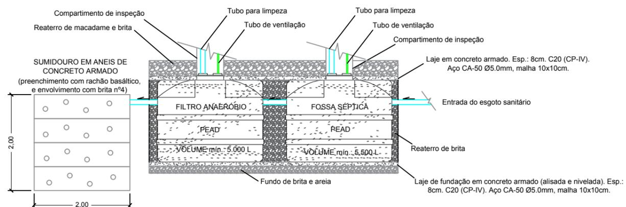
**OBS:** todo o sistema fossa-filtro-sumidouro deverá ser instalado conforme orientação contida no manual de instalação, de operação e de manutenção do sistema de tratamento, expedida pelo fabricante. As conexões hidrossanitárias (internas e externas), conexões de limpeza e de ventilação, bem como os preenchimentos internos da fossa e do filtro deverão seguir rigorosamente as orientações do fabricante do sistema.
